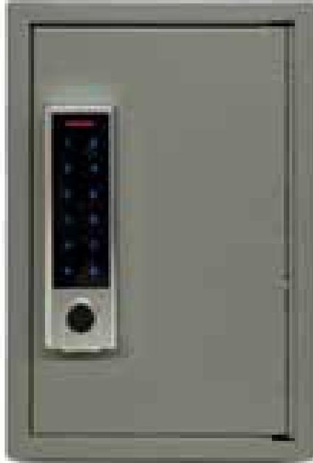
Bacheca chiavi in acciaio verniciato con apertura tramite lettore di controllo accessi a 4 tecnologie: lettore RFID (125KHz), lettore impronta digitale, PIN numerico e App Bluetooth, per apertura e per la gestione - memoria eventi, gestione di 100 utenti, completa di alimentatore a spina. Disponibile anche in versione W con bridge WIFI per gestione da remoto.
